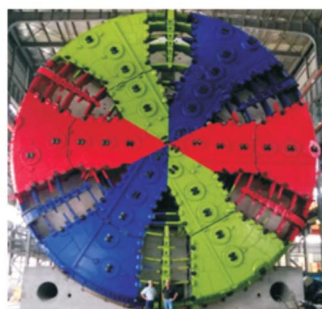
(a) 三阳路隧道盾构机
