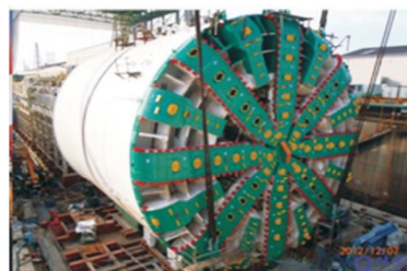
图1 西雅图SR99隧道17 m级盾构机
